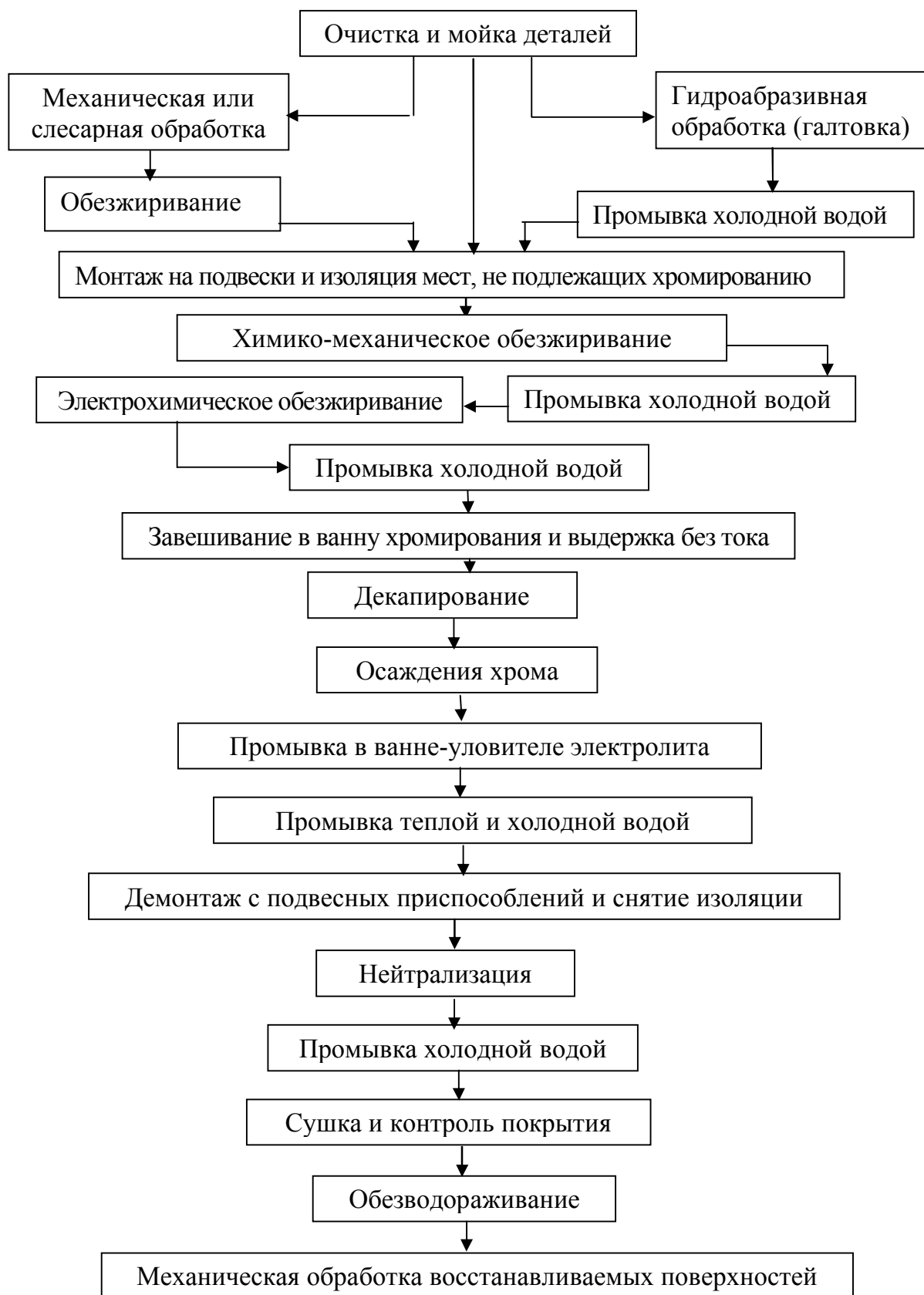
Рис. 22. Схема технологического процесса восстановления деталей электролитическим хромированием
