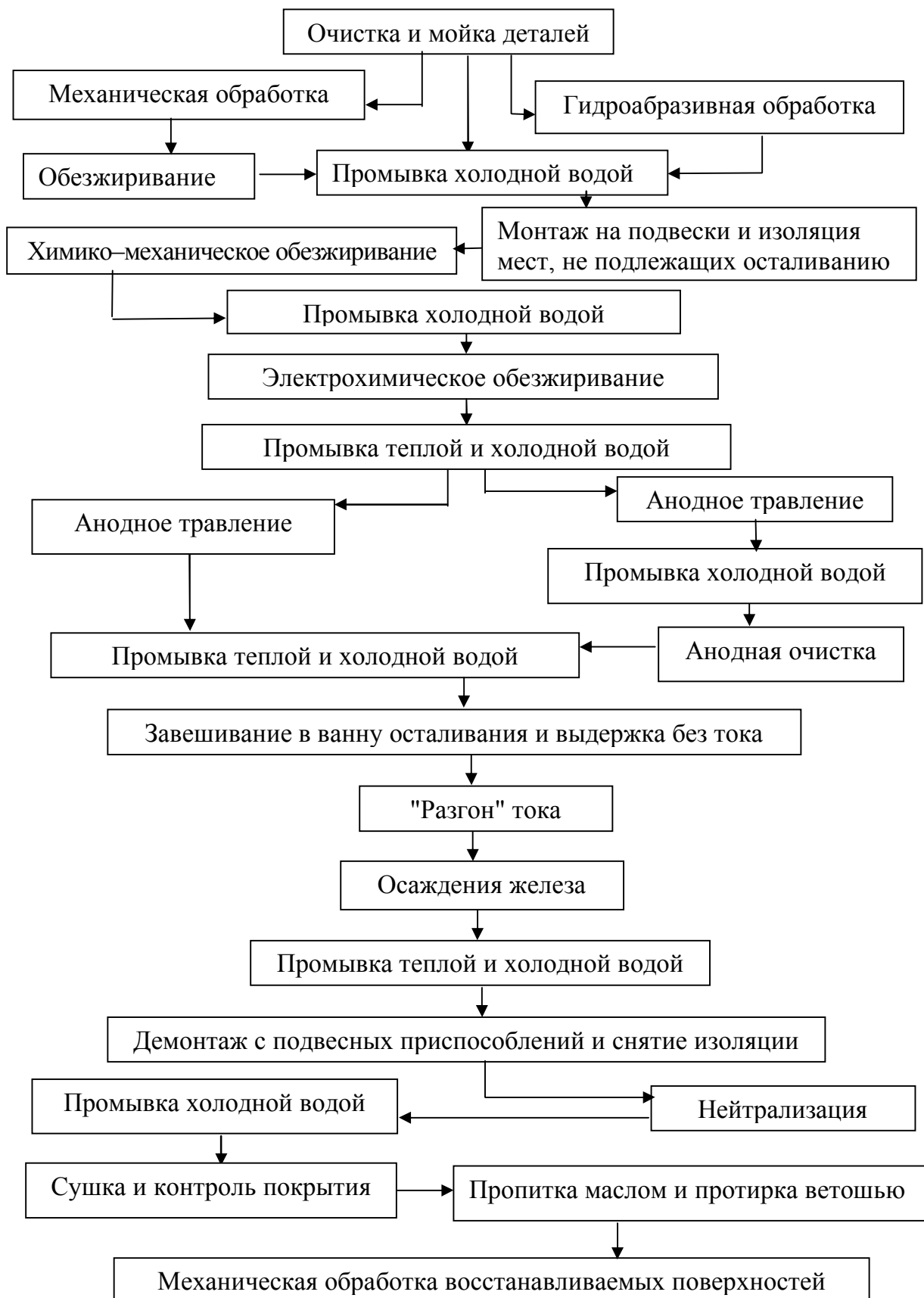
Рис. 23. Схема технологического процесса восстановления деталей твердым электролитическим железом
