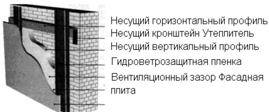
Рис. 15. Принципиальная схема системы наружной теплоизоляции «вентилируемых» фасадов
