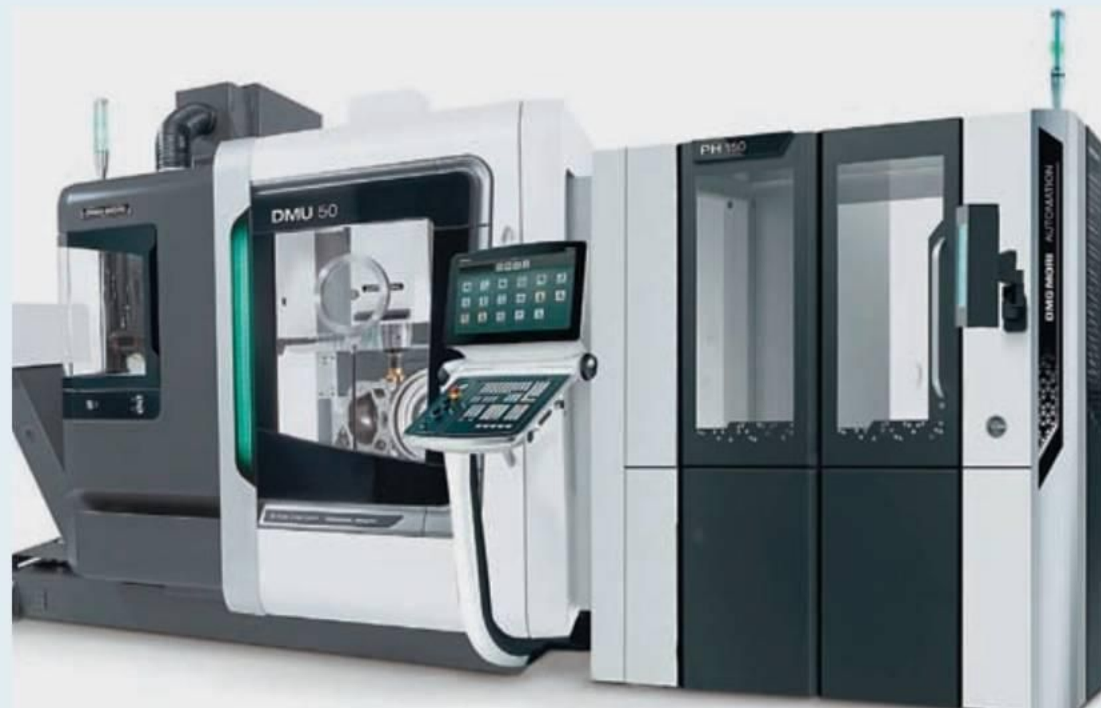
Рис. 3 PH 150 позволяет разместить до 24 палет. Максимальный размер палет \varnothing 500 x 500 мм с весом заготовки до 250 кг
