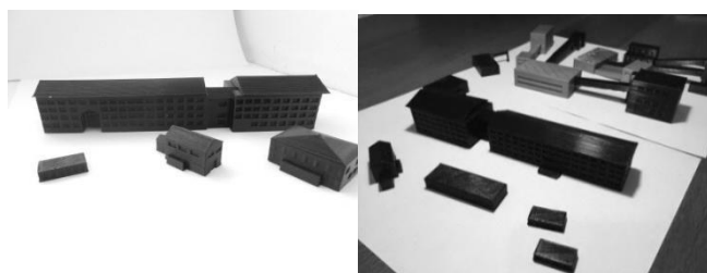
Рисунок 3– Печать архитектурных объектов (слева ABS пластиком, справа PLA)
